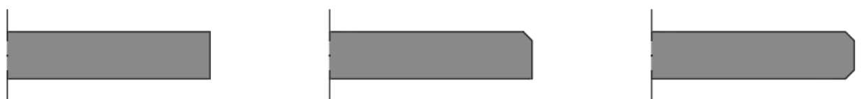
Figure 2.122 – Usinage possible des arêtes du panneau Viroc
