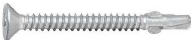
Figure 3.3 – Vis en acier galvanisé pour ossature métallique SFS Intec : SC3/25-PH2-4,8 x 35 ; Etanco : Wingteks/Zn 4,8 x 35
