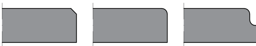
Figure 1.11 – Usinage des arêtes. Biseau, boulonnage et fraisage.
